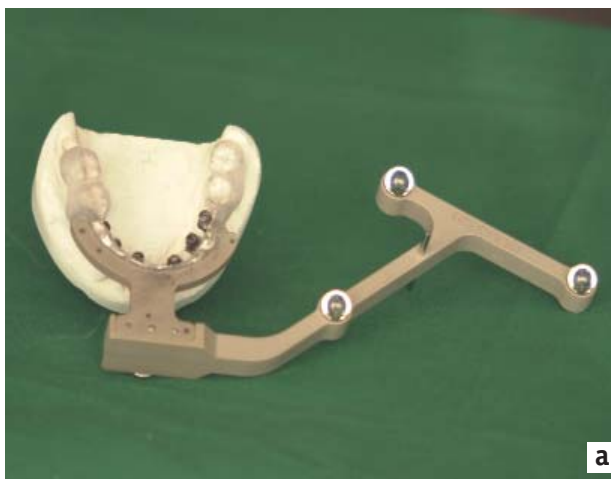
Abbildung 3 Navigationsbögen mit optischen Markern an a) Patientmodell und b) Handstück
