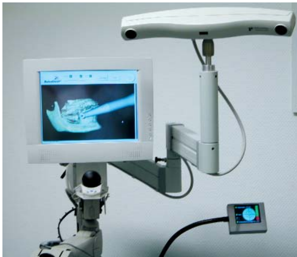
Abbildung 2 Navigationskamera und Monitore zur intraoperativen Erfassung und Darstellung von Patientenkiefer und Winkelstückposition
