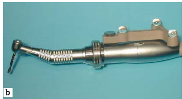
Abbildung 3 Navigationsbögen mit optischen Markern an a) Patientmodell und b) Handstück
